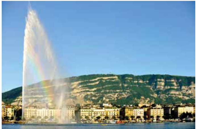
Photo 1 – Inventé presque par hasard à la fin du XIX e siècle pour gérer les surpressions hydrauliques dues à l'arrêt des machines des artisans genevois pendant la nuit, le jet d'eau devient progressivement un emblème de la ville de Genève. Depuis 1951, il culmine à 140 m, propulsé à 200 km/h par une station de pompage autonome utilisant l'eau du lac. (© État de Genève)
